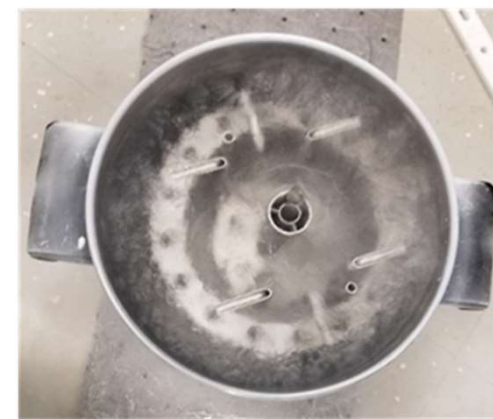
Injector submerged after LN 2 pour
