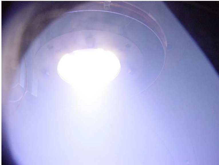
Metal Ion Source (Ar+Cr plasma)
