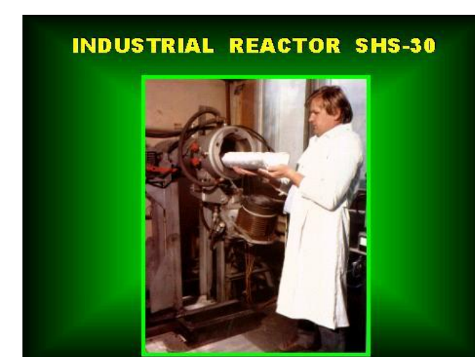
An industrial SHS reactor (www.ism.ac.ru/handbook/shsf.htm)
