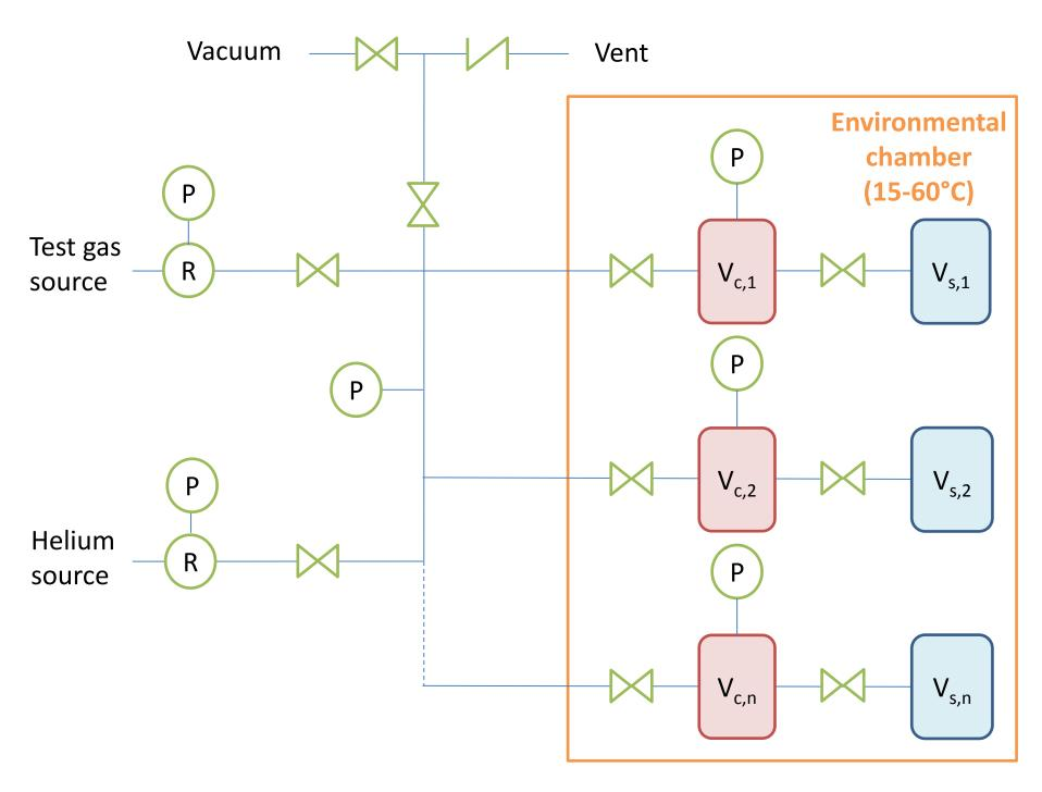
$$n_{s,m} = n_{s,m-1} + \left[ \frac{p_{o,m}V_c}{RTZ_{o,m}} + \frac{p_{f,m-1}(V_s - V_l)}{RTZ_{f,m-1}} - \frac{p_{f,m}(V_c + V_s - V_l)}{RTZ_{f,m}} \right]$$
