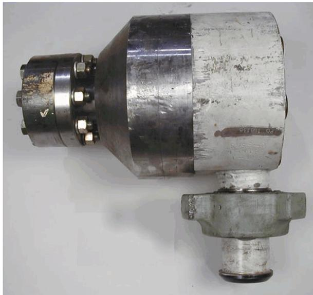
Figure 19. Hydra-Rig HP-CT Swivel
