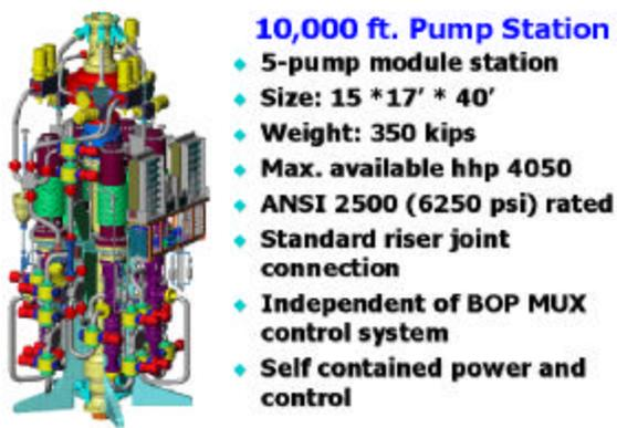
Figure 10-7. DEEPVISION Subsea Module
