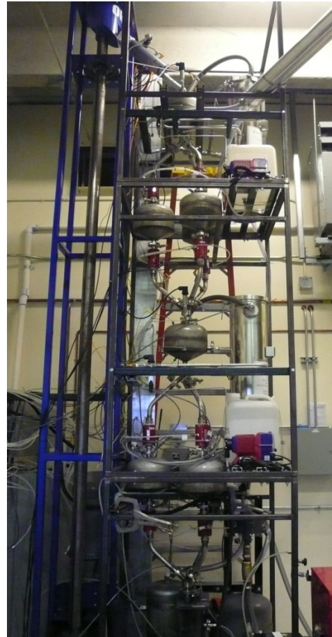
Moving-bed VSA Unit
